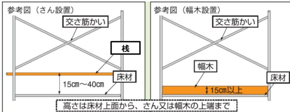
※ 幅木：「幅木」とは、つま先板ともいい、物体の落下及び足の踏みはずしを防止するために作業床の外縁に取り付ける**木製又は金属製の板**をいうものであること。（平成21年3月11日 基発第0311001号＜抜粋＞）
