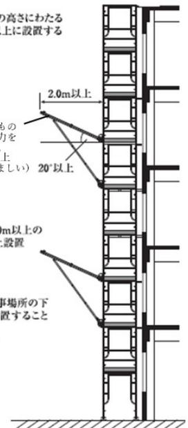
※ 施工者は、屋外での工事期間が長期間に渡る場合及び歩行者の多い場合においては、原則として、防護構台（荷重及び外力に十分耐える構造のもの）を設置すること。なお、外部足場の外側より水平距離で2m以上の幅を有する防護構台を設けた場合、第23の規定による最下段の防護棚は省略することができる。（同要綱 第24）
